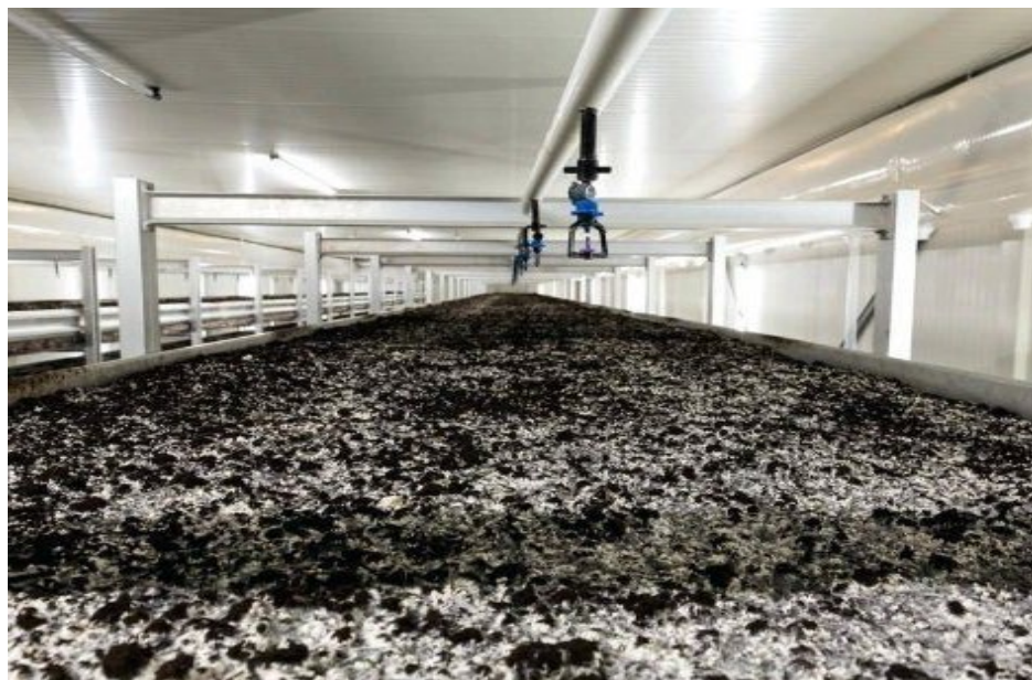
Рисунок 1.8 – Полив с помощью трубопроводов
