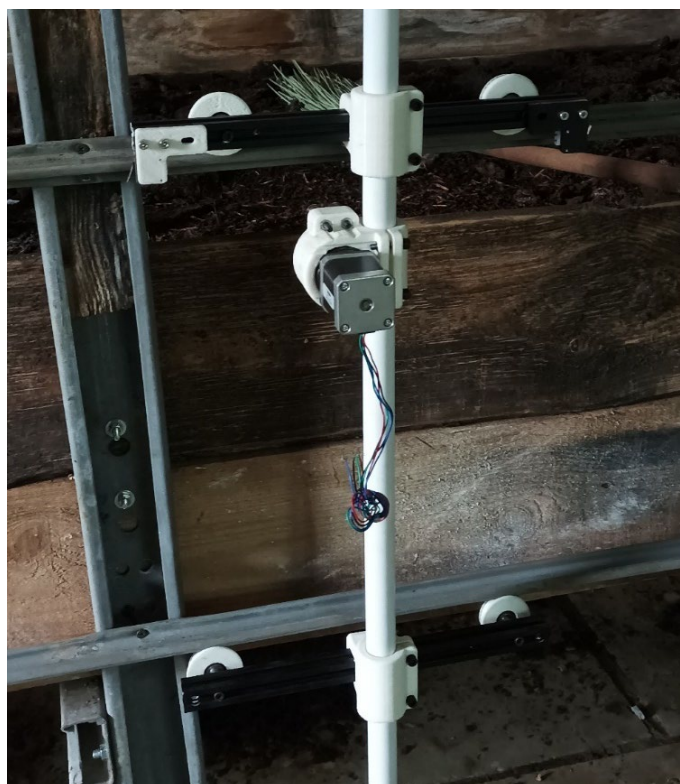
Рисунок 2.3 – Механизм привода движения поливной установки
